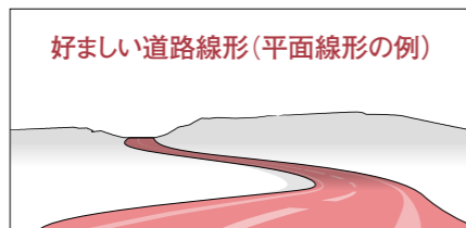
好ましい道路線形(平面線形の例) (注1)平面線形は、平面線形の3要素—直線、円、緩和曲線—が様々に組み合わせられて構成される。
