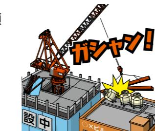
建設業者が建物建築中に、クレーン操作を誤り隣ビルの給水タンクを損壊。修理費が時価額を超えたが、修理費の全額を請求されてしまった。
