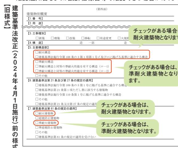
注2 「主要構造部<sup>※1</sup>が耐火構造の建物」または「主要構造部<sup>※1</sup>が建築基準法施行令第108条の4第1項第1号イ及びロに掲げる基準<sup>※2</sup>に適合する構造の建物」をいいます。
